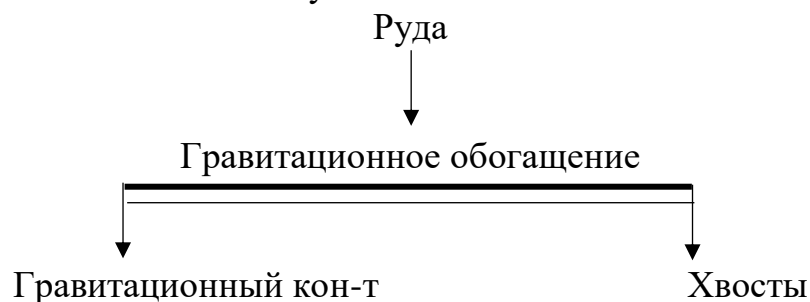
Рисунок 3.7 – Схема обогащения руд месторождения «РайГородок»
